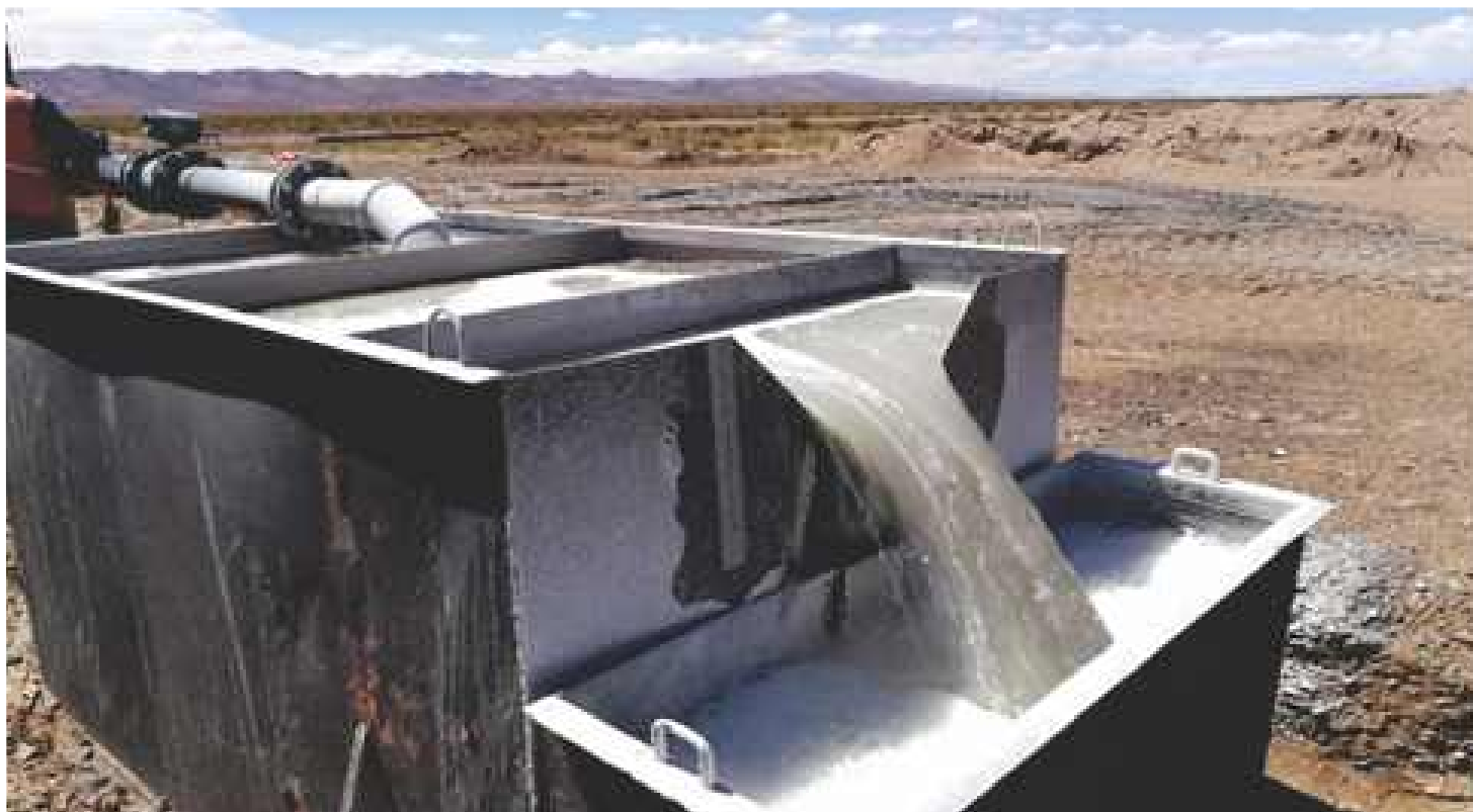
Prueba de bombeo
